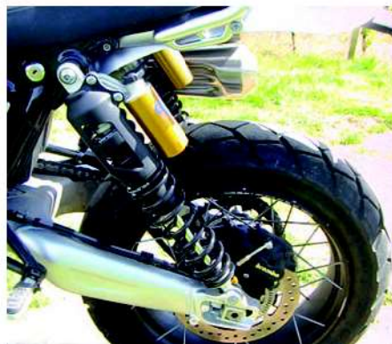
Amortisseurs à gaz, combinés Ohlins à paramétrage manuel.
